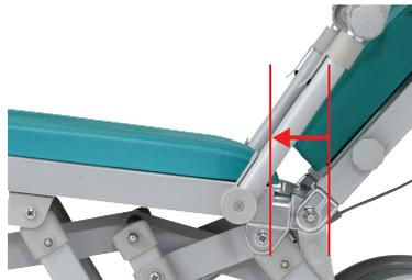
リクライニング時には座面が前に移動しながら低くなりますので、車体の重心が安定し、後方に倒れにくい構造です。(重心移動)。また、座面の角度が上がり身体のズレ防止に役立ちます。
