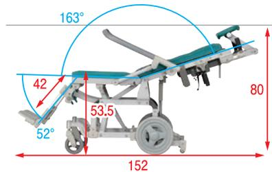
●ハンドル下のリクライニングレバーを握りながら、背もたれを倒します。背もたれは97°~163°の間で無段階に調整が可能です。連動してフットレスが上昇します。連動を解除させることも可能です。リクライニングをすることで、座面にかかる体圧を分散させることができ、座位保持が困難な方の移動がラクになります。
