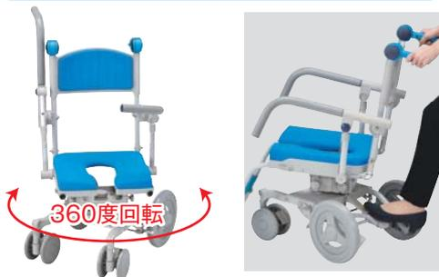
座面は360度回転(45度ごとにロック)します。回転ロックレバーを踏み、ハンドルで左右に回すと回転します。短奥行仕様時にフットプレートを折りたたんだ状態での回転操作は座面高さ3段階目からとなります。
