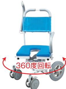
座面は360度回転(45度ごとにロック)します。回転ロックレバーを踏み、ハンドルで左右に回すと回転します。短奥行仕様時にフットプレートを折りたたんだ状態での回転操作は座面高さ3段階目からとなります。
