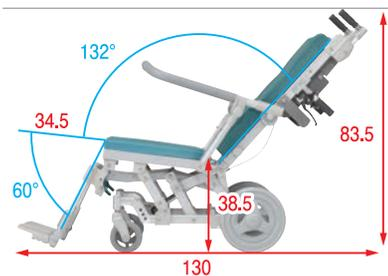
●ハンドルのリクライニングレバーを握りながら、背もたれを倒します。背もたれは101°~132°の間で無段階に調整が可能です。連動してフットレスが上昇します。連動を解除させることも可能です。リクライニングをすることで、座面にかかる体圧を分散させることができ、座位保持が困難な方の移動がラクになります。
