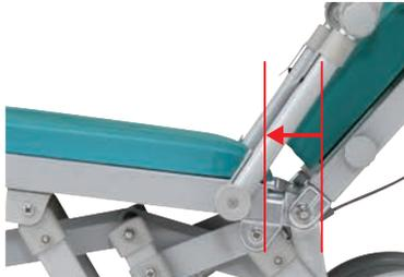
リクライニング時には座面が前に移動しながら低くなりますので、車体の重心が安定し、後方に倒れにくい構造です。(重心移動)。また、座面の角度が上がれば身体のズレ防止に役立ちます。
