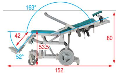
●ハンドル下のリクライニングレバーを握りながら、背もたれを倒します。背もたれは97°~163°の間で無段階に調整が可能です。連動してフットレスが上昇します。連動を解除させることも可能です。リクライニングをすることで、座面にかかる体圧を分散させることができ、座位保持が困難な方の移動がラクになります。 ※背と脚を個別に角度調整する事はできません。 ※記載の角度は概寸になります。
