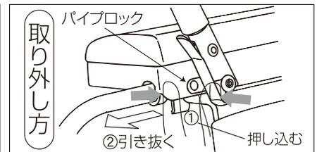
①内側と外側にあるパイプブロックを指で挟むようにして押し込み、ロックを解除してください。
