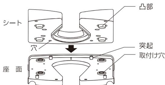
シートを取り付ける際は、シート裏面の凸部と穴を座面の取付け穴と突起にそれぞれ合わせ、上からしっかりと押しつけてください。
