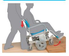
ハンドルを真下に荷重をかければ本体のバネによっ て前輪が上がりますので、弱い力で部屋の敷居や小 さい段差(最大10cm)を乗り越えられます。
