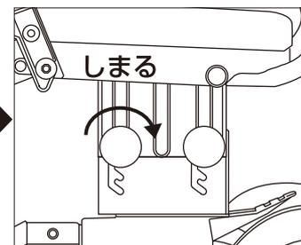
4. +ドライバー(#3)を使用し、4つのノブナットをしっかりと締めてください。(写真①)
