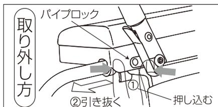
①内側と外側にあるパイプロックを指で挟むようにして押し込み、ロックを解除してください。
