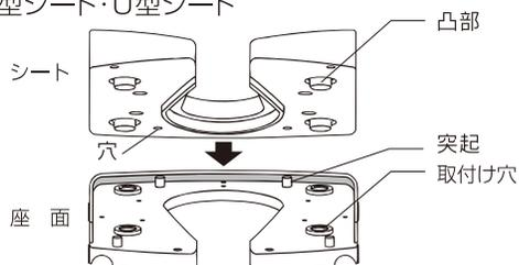
シートを取り付ける際は座面の後方に合わせてから、シート裏面の凸部と穴を座面の取付け穴と突起にそれぞれ合わせてから、上からしっかりと押しつけてください。
