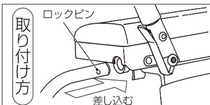
フットレストパイプをカチッと音がするまで差し込んでください。パイプを少し回転させながら差し込む、もしくはロックピンを押しながら差し込むと、入りやすくなります。
