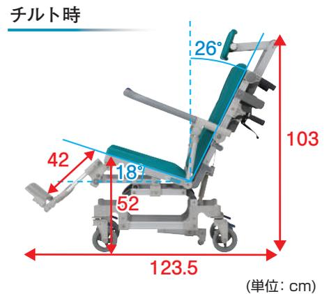
ハンドル下のチルトレバーを握りながら、ハンドルを押し下げるとチルトができます。チルト角度は105°~116°の間で無段階に調整が可能です。座面にかかる体圧を分散させ、体のズレを防ぎ、安定した姿勢を保つことが可能です。楽な姿勢で体が洗えます。
