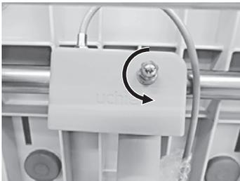
①10mmレンチで袋ナット(6mm)を反時計回りでナットを外すとカバーが外れます。
