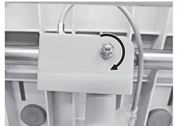
④10mmレンチで袋ナット(6mm)を時計回りに締めてください。
