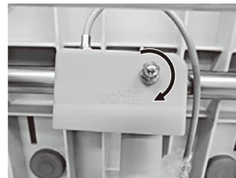
④10mmレンチで袋ナット(6mm)を時計回りに締めてください。
