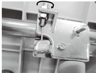
③下のナットはそのままにして、上のナットだけを時計回りにしっかり締めてください。
