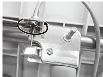
②図のようにリクライニングワイヤーの下のナットを少しずつ反時計回りにゆるめてください。リクライニングが楽にできるように調整してください。
