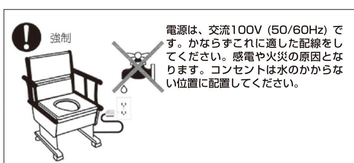
電源は、交流100V (50/60Hz) です。かならずこれに適した配線をしてください。感電や火災の原因となります。コンセントは水のかからない位置に配置してください。
