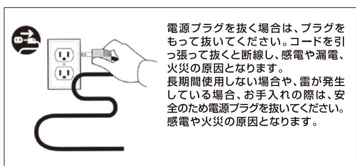
電源プラグを抜く場合は、プラグをもって抜いてください。コードを引っ張って抜くと断線し、感電や漏電、火災の原因となります。
